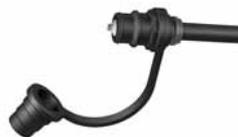
2. Zuführungsleitung an die HydroLink-Leitung im Fahrzeug anschließen.
